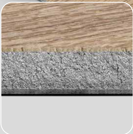
Denscore PRO Mineralkern, hergestellt im Extrusionsverfahren aus Kalziumkarbonat und Veredelungszusätzen; Stärke: bis zu 4,5 mm
